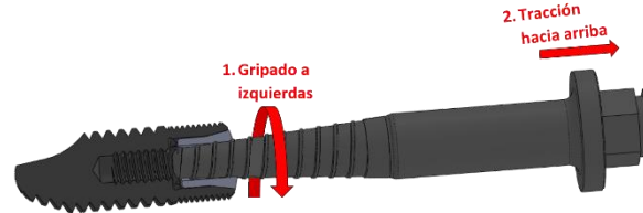
Fig. 6 Operativa de trabajo con elemento de rescate de prótesis InHex
